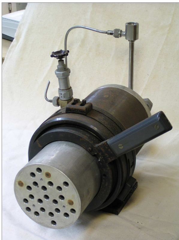
Многоэлементный ХФЛ с параллельным расположением АЭ и светящихся каналов
