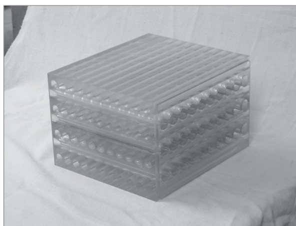
Внутренняя часть многоэлементного ХФЛ типа «световой котел»
