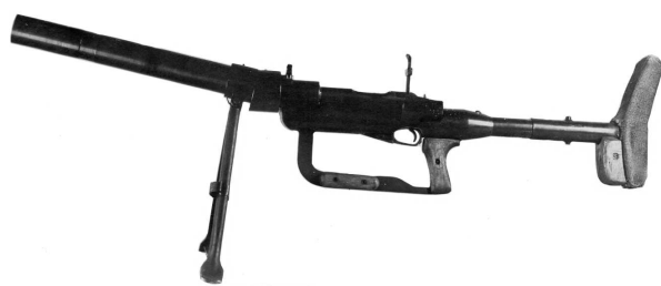
Рис. 4 Общий вид гранатомета ПГ-6
