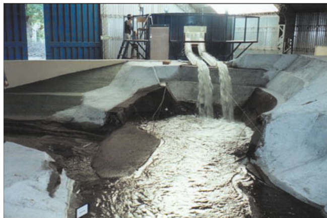
Рис. 6. Исследование размыва грунта основания при работе туннельного водосброса ГЭС Лос-Караколес
