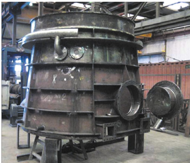
Рис. 15. ГЭС Пунта-Негра: сборка облицовки конуса отсасывающей трубы на местном заводе
