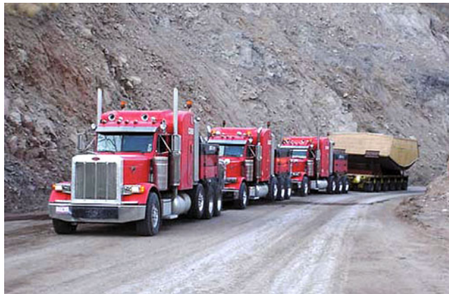
Рис. 14. ГЭС Ла Йеска: транспортировка сектора статора гидрогенератора
