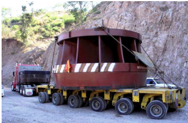
Рис. 13. ГЭС Ла Йеска: транспортировка рабочего колеса гидротурбины
